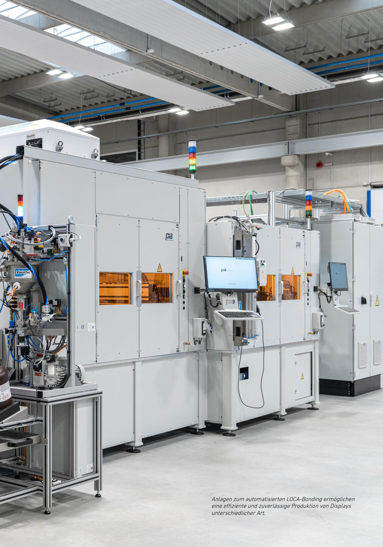
Anlagen zum automatisierten LOCA-Bonding ermöglichen eine effiziente und zuverlässige Produktion von Displays unterschiedlicher Art.
