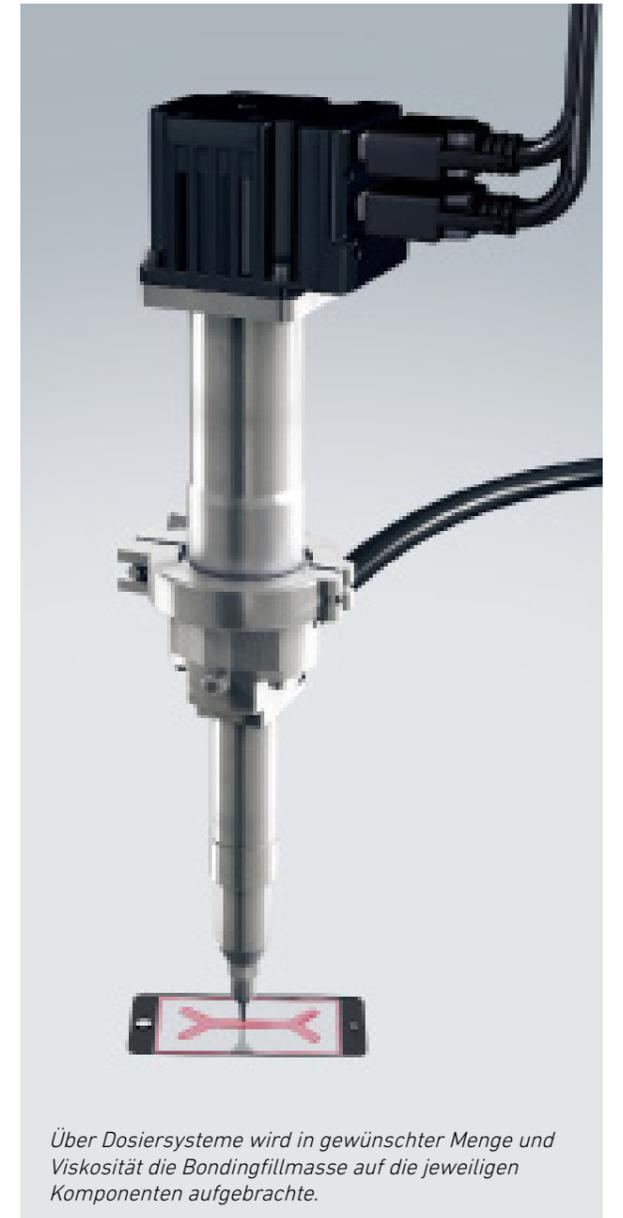
Über Dosiersysteme wird in gewünschter Menge und Viskosität die Bondingfillmasse auf die jeweiligen Komponenten aufgebracht.
